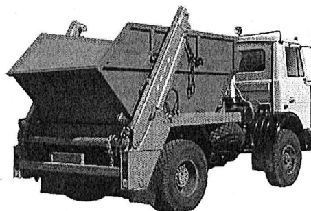
Рис. 4.16. Бункеровоз МКС-3501 на шасси МАЗ-5551А2
